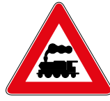
T-36 Kontrolsüz demir yolu geçidi
